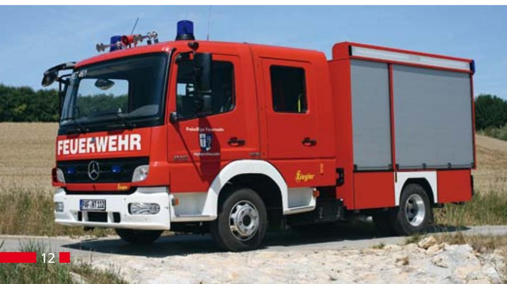
◀ TSF-W, Baujahr 2009, FF Hettenshausen (Lkr. Pfaffenhofen a.d.Ilm (Obb.)). MB Atego 816 F, 115 kW (156 PS); z.G. 7 490 kg; 600 l Wasser, im Heck Ziegler TS (PFPN 10-1000). In der Kabine vier Pressluftatmer aufnahmebereit. Besatzung 1+5. Aufbau: Ziegler.
