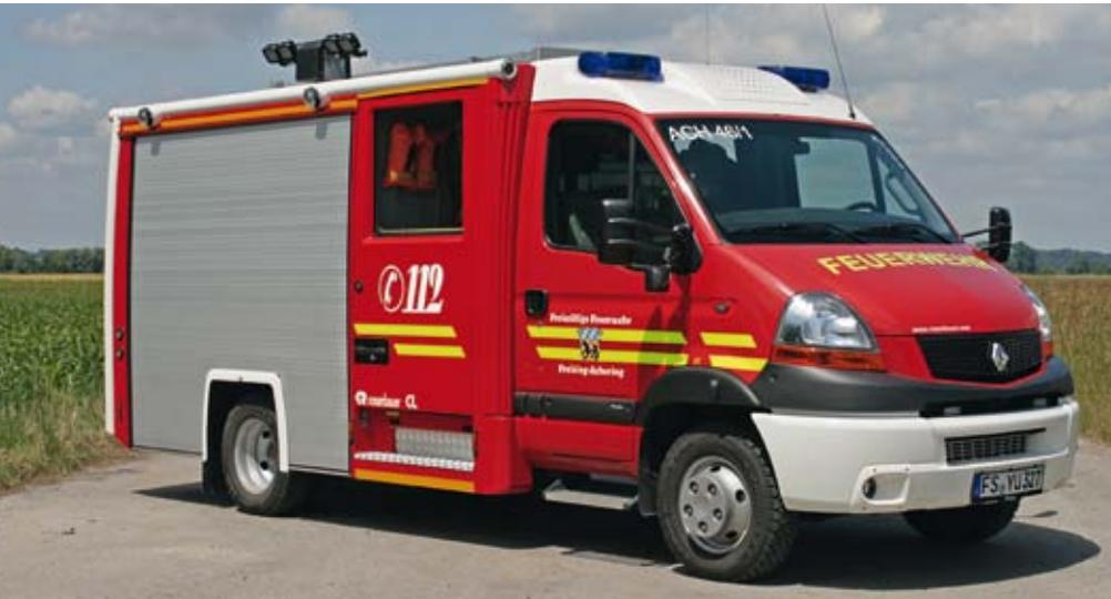
◀ TSF-W, Baujahr 2010, FF Freising-Achering (Lkr. Freising/Obb.). Renault Master 150 dCi, 110 kW (150 PS), z.G. 6 500 kg. Besatzung 1+5. 750 l Wasser, im Heck TS „Fox“, Schnellangriff auf Haspel, 50 m lang. In der Kabine 4 PA aufnahmebereit. Aufbau: Rosenbauer (CL Bauweise).
