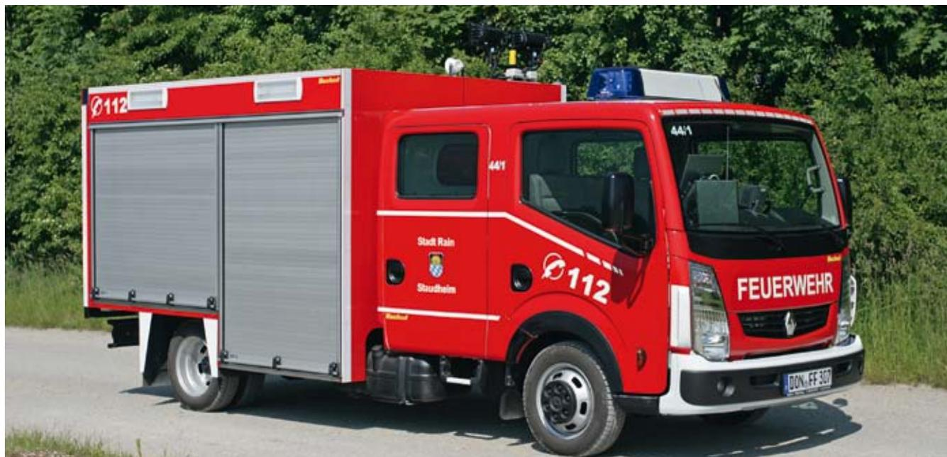
▲ TSF, Baujahr 2011, FF Staudheim (Stadtteil von Rain am Lech/Lkr. Donau-Ries/Schwaben). Renault Maxity DX13 150.45, 110 kW (150 PS); z.G. 4 500 kg. TS Fox II (1600 l/min) im Heck, außerdem Lichtmast und Generator. Aufbau: Bachert (Kirchgässner). Besonderheiten: Computeranlage mit Bildschirmen im Fahrerhaus und im Heckraum, Sprachansage mit Gefahrenhinweisen sowie Oertzen-Hochdruck-Löschanlage HDL 170 und IFEX 3000 Impuls-Lösch-Technologie. Erstes derartiges Renault-Fahrzeug in Bayern!
