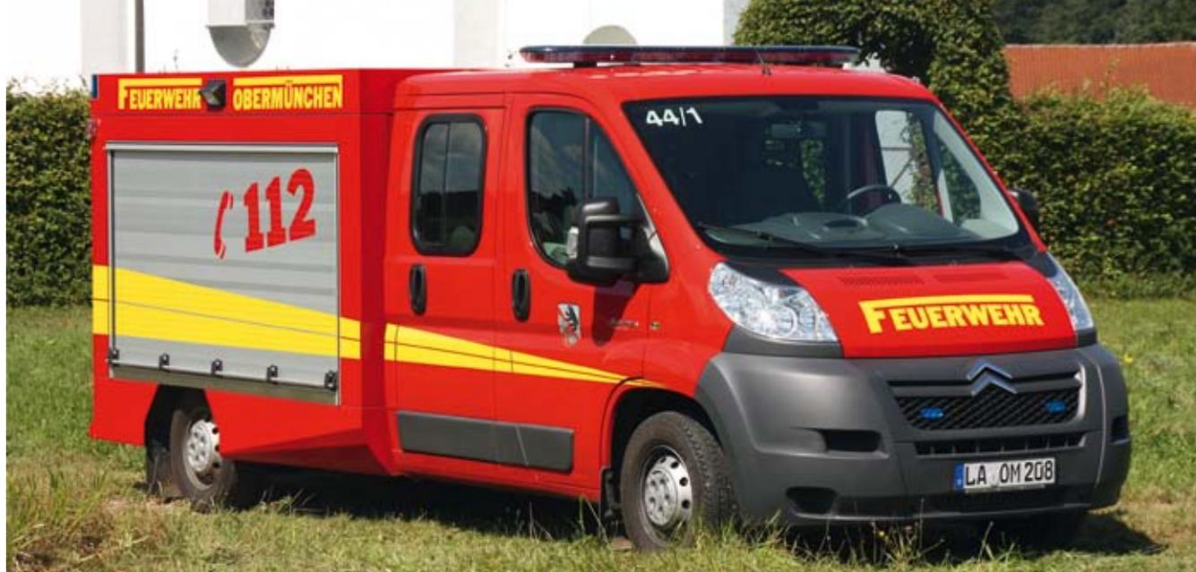
▲ TSF, Baujahr 2008, FF Obermünchen, Ortsteil von Obersüßbach (Lkr. Landshut/Nb.). Citroën Jumper 2,8 HDI, 88 kW (120 PS); z.G. 3 500 kg. Besatzung 1+5. Aufbau: Oettl.
